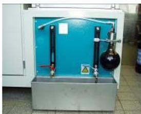
Асфальтоанализаторы предназначены для экстракции и определения содержания битума в асфальтобетонных смесях, отделения каменного материала от вяжущего, с использованием пожаробезопасного растворителя трихлорэтилена (точка кипения + 87 °С, плотность 1462 – 1466).
