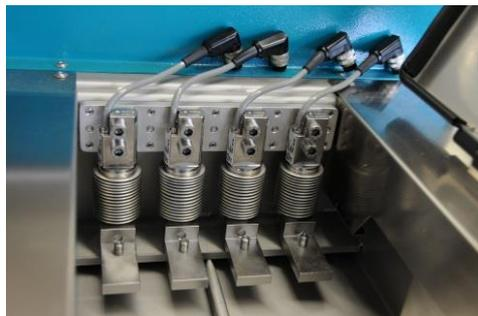
В стандартной комплектации датчиком усилия с максимальным фиксируемым усилием 500 Н оборудовано 1 рабочее место из четырех (разрешающая способность датчика 0,02 Н, по желанию – специальный вариант оснащения 100 Н, разрешающая способность 0,004 Н).
