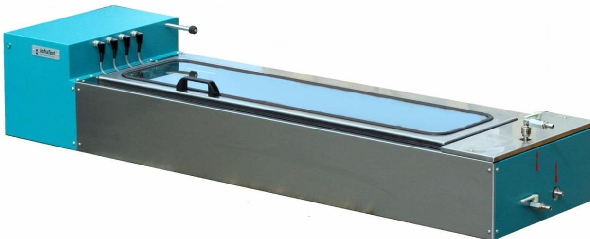
Дуктилометр предназначен для определения характеристик растяжимости и эластичности битумных вяжущих согласно стандартам ГОСТ 11505, EN 13398/13587/13589, ASTM D 113, AASHTO T 51.
