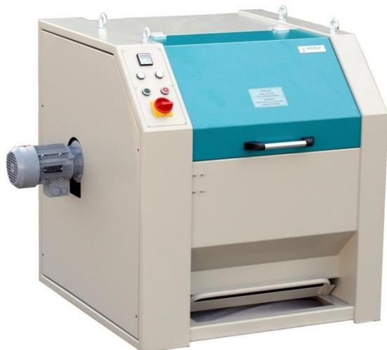
Для проведения испытаний согласно EN 1097/2 – ASTM C 131/535 – AASHTO T 96 на определение сопротивляемости щебня абразивному износу. Машина состоит из надежного стального корпуса с защитной откидной крышкой, внутри которого помещен стальной барабан с электроприводом, вращающийся со скоростью 30 об/мин. Встроенный таймер останавливает испытание по достижению необходимого по стандарту числа оборотов барабана. Металлические шары по EN 1097/2 и другим стандартам заказываются дополнительно.
