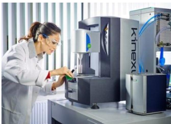
Kinexus DSR/DSR+ - динамический сдвиговой реометр для рутинного контроля качества битумных вяжущих с технологией "plug and play" для всех измерительных геометрий и систем температурной стабилизации. Kinexus DSR позволяет проводить тестирования с помощью инновационной системы стандартизованных операционных процедур (SOP/СОП) со встроенной библиотекой стандартных протоколов испытаний дорожно-строительных материалов, а также в режиме стандартных реологических тестов.
