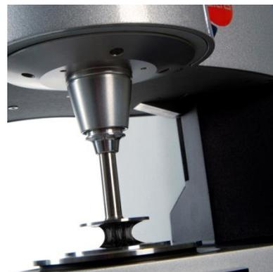
Ротационный реометр Kinexus DSR создан для удовлетворения потребностей дорожно-строительной промышленности. Принцип действия заключается в приложении к испытуемому образцу регулируемой деформации сдвига с целью измерения свойств текучести (таких как сдвиговая вязкость, получаемая при испытаниях на текучесть) и динамических свойств материала (такие как комплексный модуль/модуль вязкоупругости и фазовый угол, получаемые из испытаний методом вынужденных колебаний/осцилляций).
