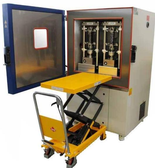
Установка представляет собой климатическую камеру, с испытательным стендом - разрушающим устройством, и предназначена для исследования поведения асфальтобетона под воздействием температуры.
