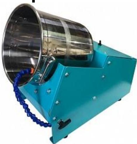
Машина предназначена для отмывки сыпучих/каменных материалов, наклонный барабан вращается с заданной скоростью, во время вращения материала гибким шлангом в материал подается вода, мелкие/пылеватые частицы смешиваются с водой и вымываются из барабана машины, чтобы быть задержанными на сите нужного размера, устанавливаемом дополнительно.
