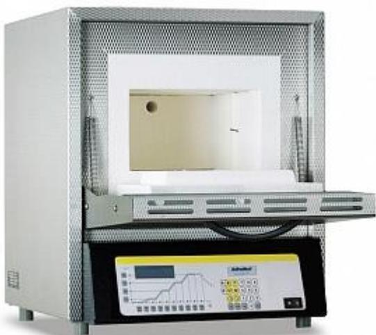
Корпус печи выполнен из высококачественной стали с двойными стенками и подпружиненной дверцей, открывающейся вниз. В задней стенке предусмотрено отверстие для отвода воздуха, регулируемое отверстие для приточного воздуха в дверце. Нагрев осуществляется посредством керамических пластин со встроенными нагревательными элементами и цифровым ПИД-регулятором с 9-ю свободно программируемыми режимами.
