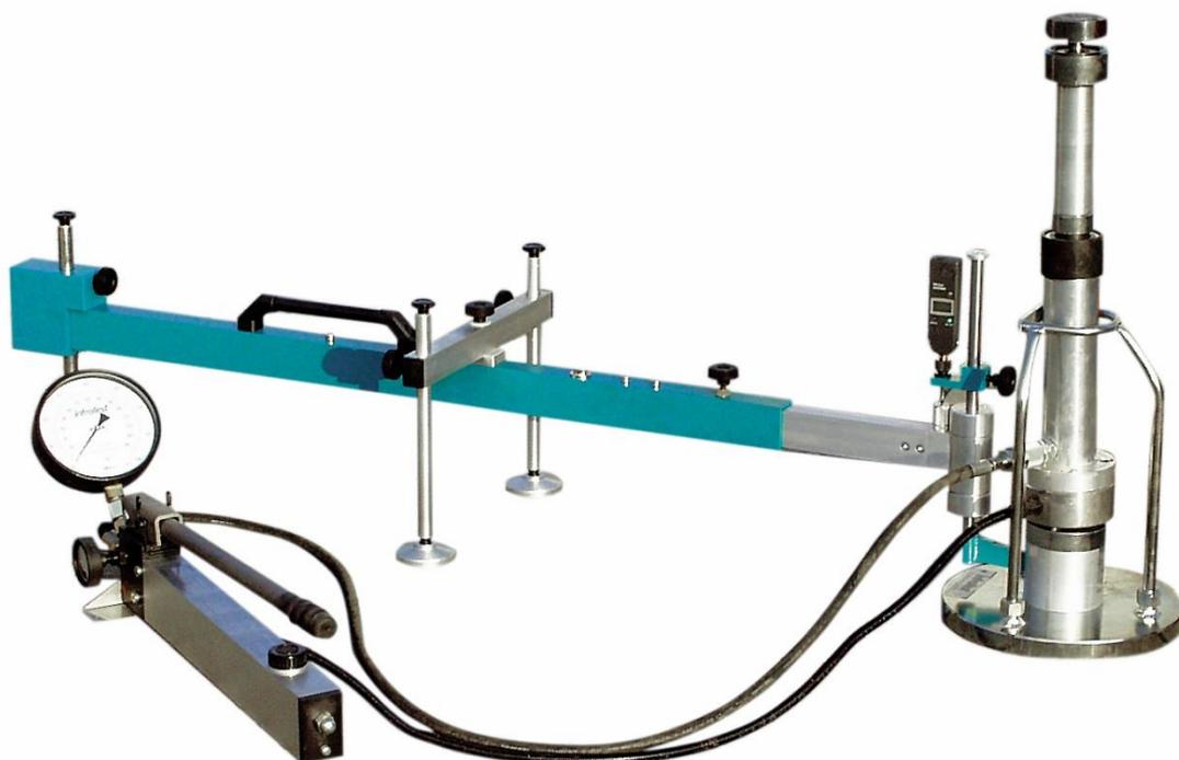
Статический прибор для проведения испытаний согласно DIN 18134 • BS 1377 • ASTM D 1194 / 1195 1196 для определения деформируемости и несущей способности грунтов. Нагружаемая плита с помощью гидравлической системы и противовеса (тяжелой строительной техники) подвергается ступенчатой нагрузке и разгрузке, соответствующая усадка определяется с помощью мостовой схемы измерения.
