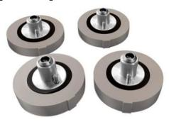
Устройство для растрескивания асфальтового вяжущего ABCD необходимо для проверки низкотемпературных свойств битумных вяжущих.
