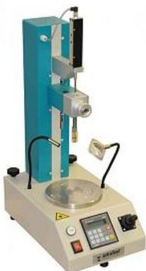
Пенетрометр сконструирован на прочной раме, основание регулируется для достижения горизонтального положения прибора. Плунжер, создающий испытательную нагрузку, фиксируется и освобождается автоматически под управлением микроконтроллера, по заданному оператором времени в пределах от 0,1 секунды до 99,99 часов.
