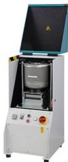
Гранулятор асфальтобетонной смеси предназначен для измельчения асфальтобетонной смеси при определении объемной плотности. Специальный рабочий орган позволяет измельчать образцы асфальтобетонной смеси не допуская дробления каменного материала. Полученный гранулят может использоваться для определения объемной плотности по EN 12697/5.
