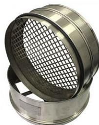
Высококачественные сита выполнены из нержавеющей стали, при размере ячеек более 4 мм. используется пластина с лазерной перфорацией отверстий, при размере ячеек менее 4 мм. применяется сетка из нержавеющей стали. Толщина перфорированной пластины каждого сита варьируется в зависимости от размера ячейки. Для заказа доступны сита диаметром обечайки 200 и 300 мм, высота обечайки от 50 до 100 мм.
