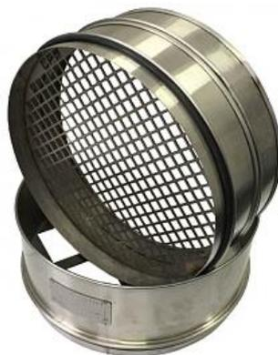
Контрольные сита лабораторные выполнены из нержавеющей стали, при размере ячеек более 4 мм. используется пластина с лазерной перфорацией отверстий, при размере ячеек менее 4 мм. применяется сетка из нержавеющей стали. Толщина перфорированной пластины каждого сита варьируется в зависимости от размера ячейки. Для заказа доступны сита диаметром обечайки 200 и 300 мм, высота обечайки от 50 до 100 мм.
