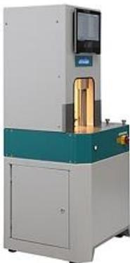
Гираторный (вращательный) уплотнитель infraTest предназначен для подготовки образцов диаметром 100 и 150 мм, различной высоты из горячей асфальтобетонной смеси согласно ПНСТ 112-2016, ASTM 6925-15, ASTM 7515-10, EN 12697-31.
